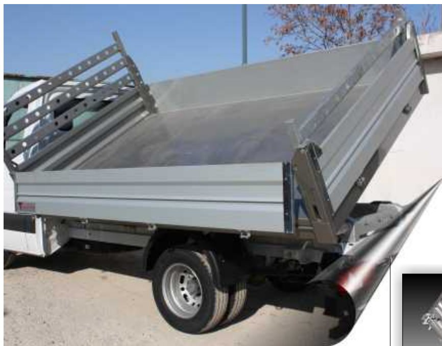
Υλικό κατασκευής πλαϊνών : αλουμίνιο
